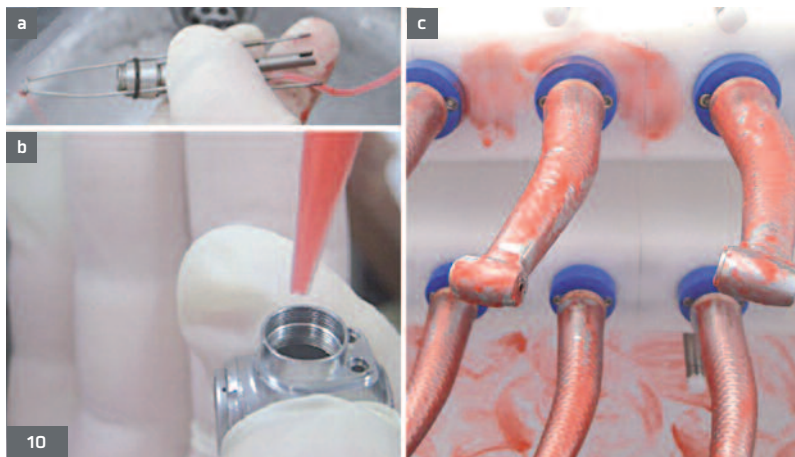
Fig. 10. Méthode de contrôle du nettoyage des PID. a. Salissure des tubulures air-eau. b. Salissure de la tête du PID. c. Connexion des PID avec salissures dans l'automate.
