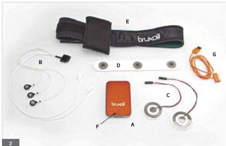
Fig. 2. Dispositif d'enregistrement portable à trois canaux permettant d'enregistrer et de scorer le bruxisme du sommeil. A. Bruxoff®. B. Câble de connexion. C. Électrodes EMG. D. Électrode cardiaque. E. Sangle thoracique. F. Bouton de marche/arrêt. G. Câble USB.
