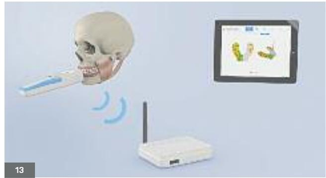
Fig. 13. Le réseau Wi-Fi du cabinet transmet les informations entre l'OccluSense et la tablette où s'affichent les résultats.
