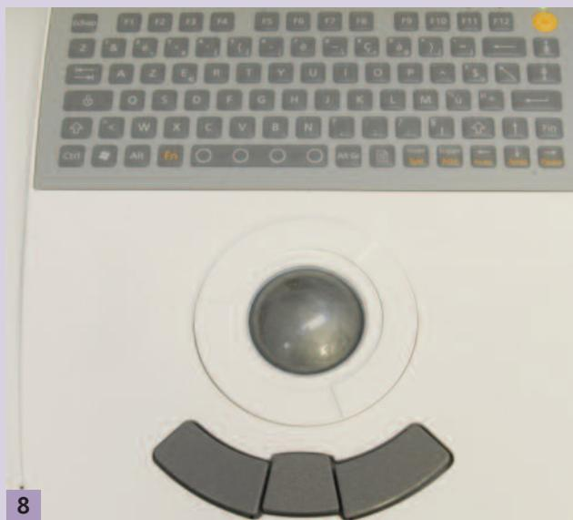
**Fig. 8 :** le clavier étanche + track ball du système CEREC AC.
